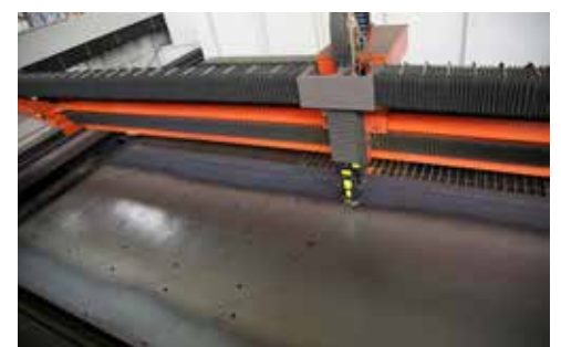
De høj-moderne plade- og rør laserskærere gør det muligt for os at producere komplekse elementer hurtigt og præcist.
