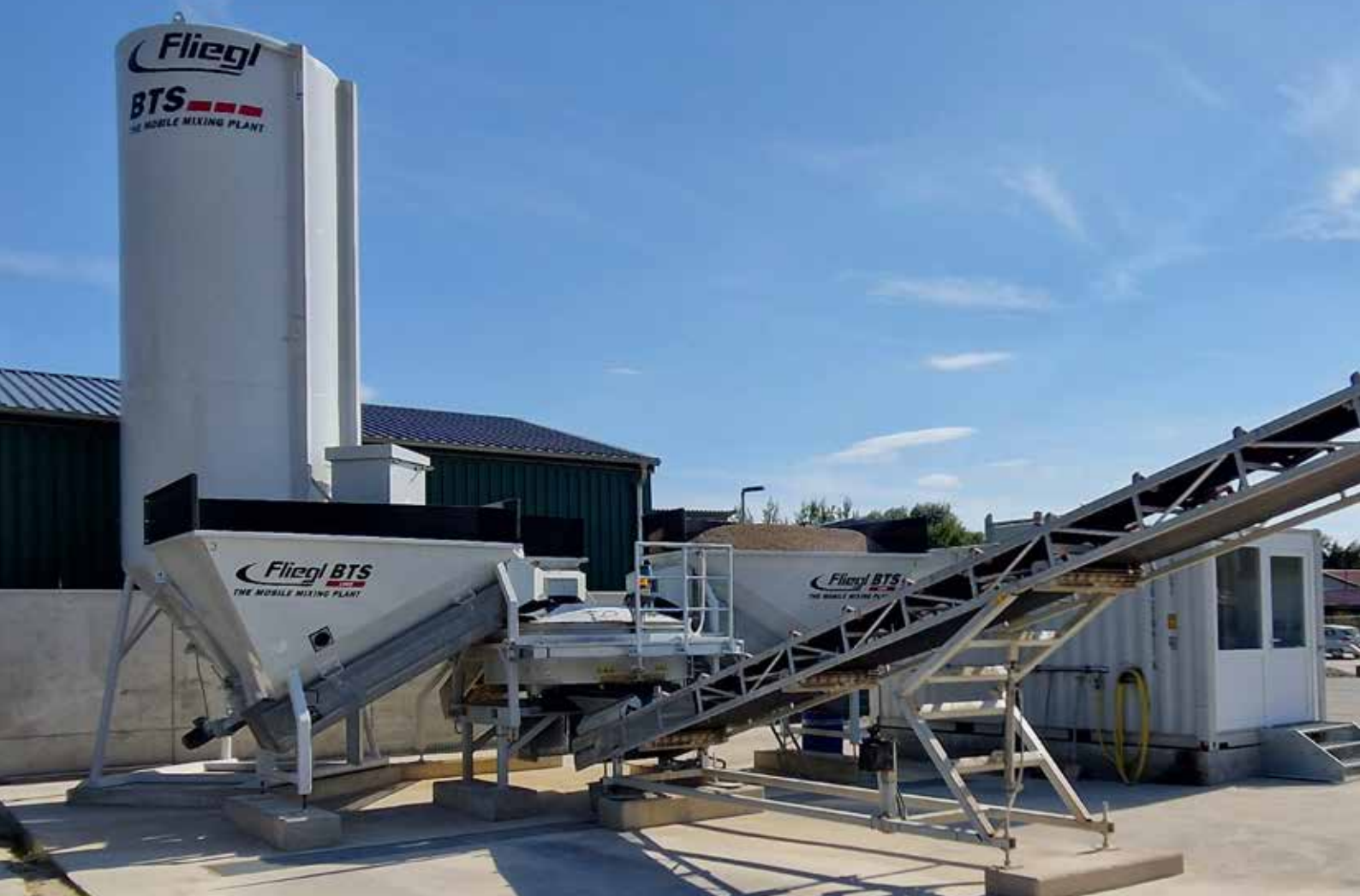
BTS 1000 1 x dobbelt aggregat-silo/2 x enkelt aggregat-silo / Terræn med hældning, strøgfundamenter jævne
